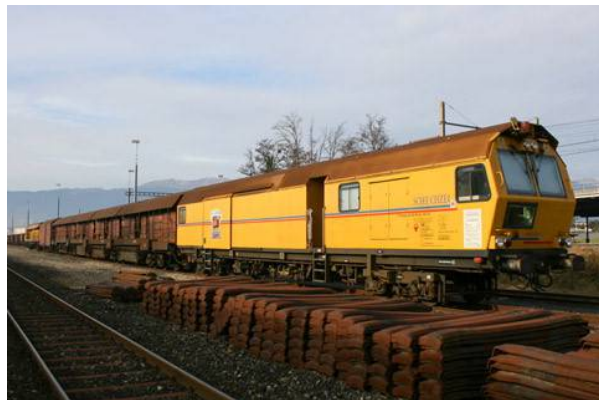
Train meuleur de rails (Scheuchzer S.A.)
