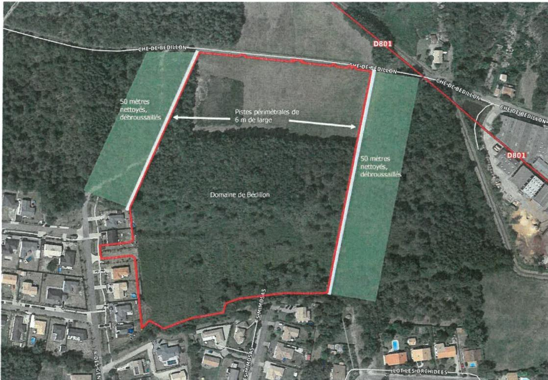
Fig. 10 : Schéma des mesures de réduction contre le risque incendie (Source : ENVOLIS)
