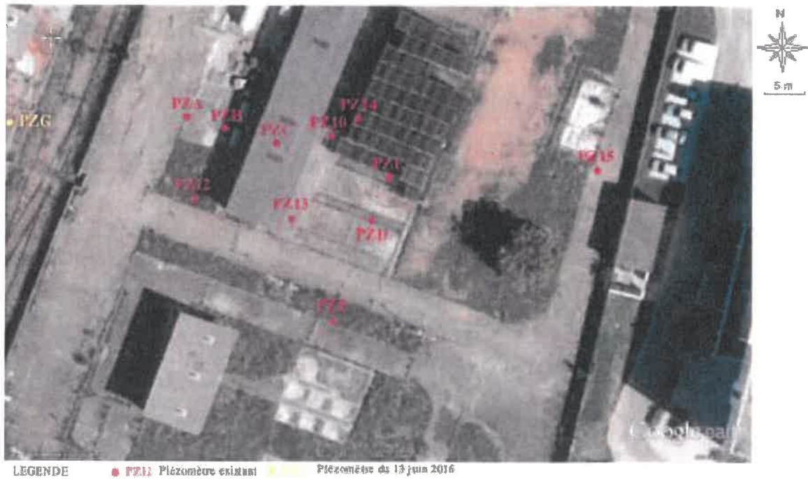
Figure n°1 : Plan d'implantation des piézomètres sur site. (98.24.A.AF(R.47.1).01.1)
