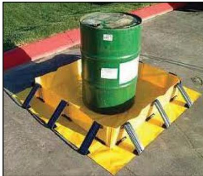
Figure 19 : Stockage de produit dangereux au sein d'un bac étanche (Source : Préfecture du Puy de Dôme)
