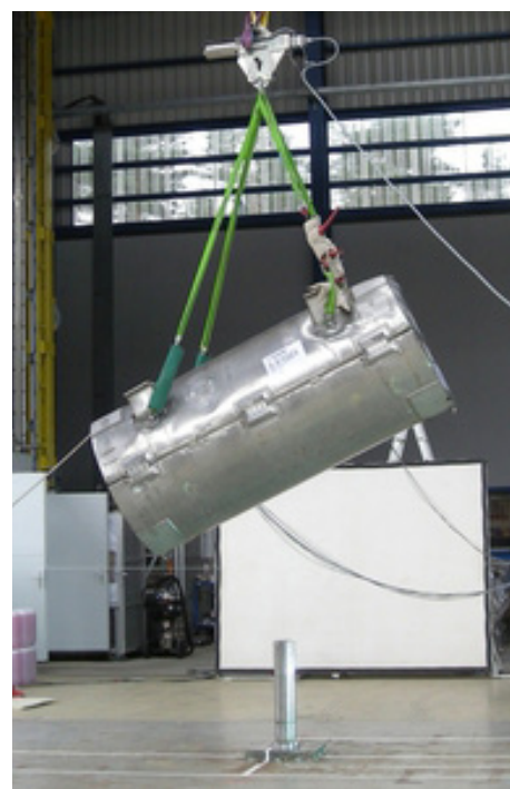
Essai de chute sur poinçon d'une maquette d'emballage DN30 de Daher-NCS
