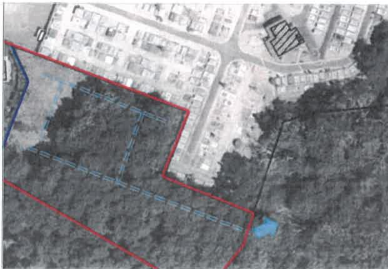
Figure 8 : Dispositif de drainage préconisé par l'hydrogéologue agréé dans son avis
