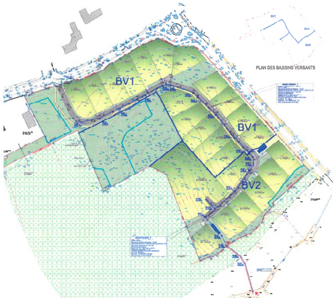
Figure 4 : Localisation des solutions compensatoires pluviales
