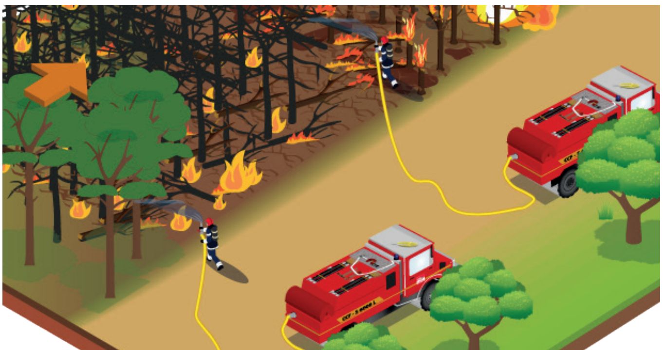
Attaque par établissement de tuyaux au sol.
